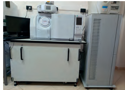
Obr. 4: Stůl s integrovaným dusíkovým generátorem CASTORE XL a na stole je GCMS
