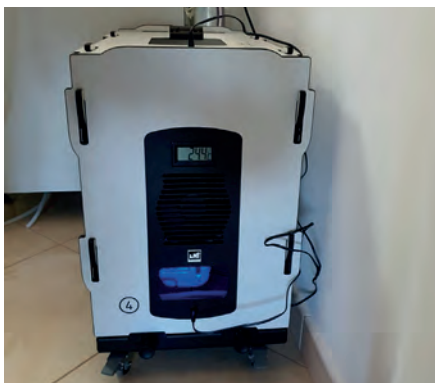
Obr. 5: Silencer (tišící box) s vakuovou pumpou pro MS uvnitř – snížení hlučnosti o 15 dB
