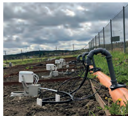
Obr. 6: Propojení analyzátorů, multiplexeru a komor v místě měření
