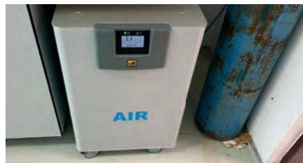
Obr. 1: Instalace generátoru nulového vzduchu pro TOC analyzátor a GC FID
